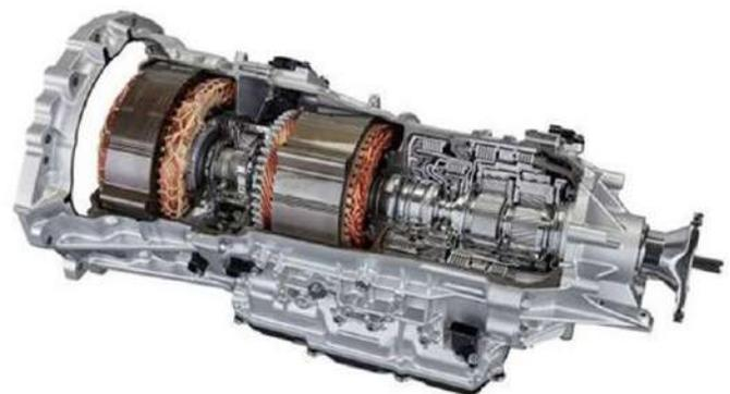
in foto Toyota Full Hybrid - Due motogeneratori che sostituiscono trasmissione, alternatore e motorino di avviamento
